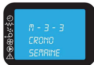
L'appareil dispose de quatre programmes hebdomadaires qui permettent quatre allumages et quatre extinctions par jour. Pour chaque plage horaire programmée, il est également possible de définir la puissance maximale de fonctionnement et la température ambiante.
