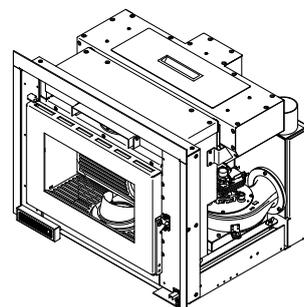
Les inserts à granulés INSIDE M9 & M11 C, sont souvent utilisés pour la rénovation d'une cheminée à foyer ouvert. Mais ils sont aussi parfaitement adaptés à une création de cheminée. La version M11 C est canalisable grâce à l'intégration d'un second ventilateur placé à l'arrière. L'INSIDE M peut être équipé de plusieurs modèles de porte (Largeur 80 cm plate ou incurvée / Largeur 70 cm plate) ces grandes portes sont entièrement vitrées et dotées de l'effet «MAGIC LIGHT».
